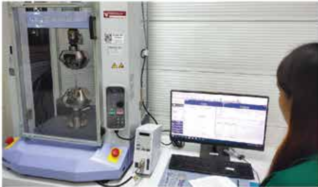
เครื่องทดสอบแรงดึง (Tensile Testing Machine)
