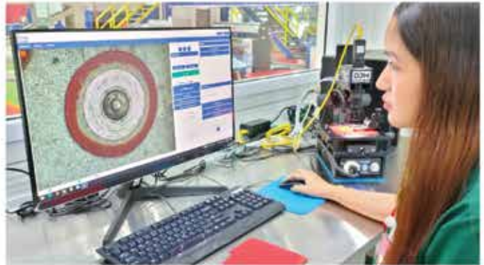
เครื่องวัดความหนาชั้นเคลือบ (DJH - Film Thickness System)
